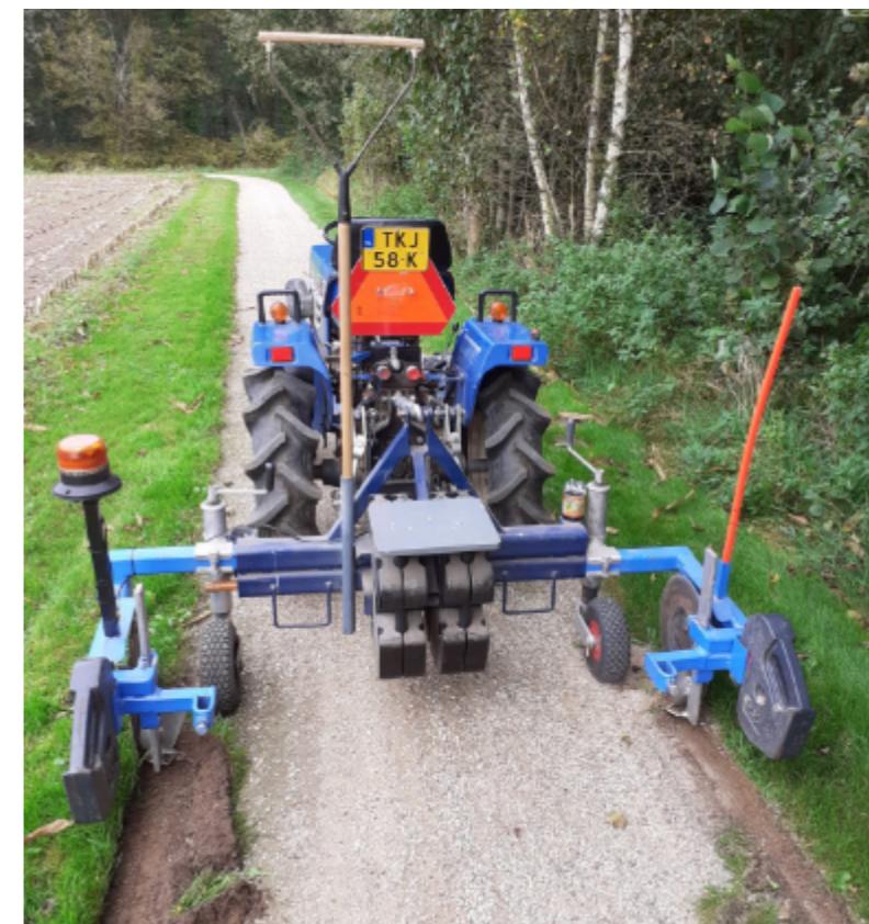
Links en boven: Sjors Borkes en zijn zelf ontworpen kantensnij- en schoffelmachine.
